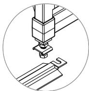
Die Laufschiene wird einfach unten an der feststehenden Camshelving Einheit befestigt. Es ist nicht erforderlich, den Boden anzubohren, um die Laufschiene festzuschrauben.
