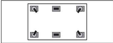
4 Lenkrollen, Eckrollen sind leicht versetzt zur Stabilisierung des Wagens auf unebenen Böden; 2 Bockrollen in der Mitte sorgen für engeren Wendekreis.
